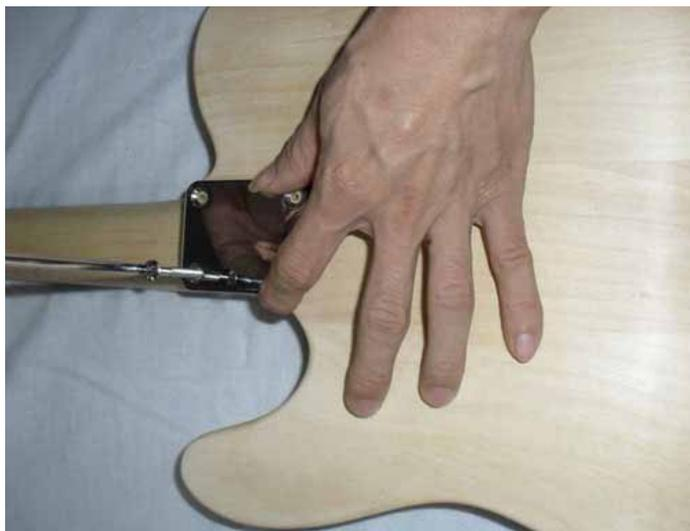
Dele la vuelta a todo el conjunto, coloque la placa de fijación (con el sello protector de color negro) encima de los cuatros orificios en la parte trasera del cuerpo y atornille el cuerpo y el mástil con los cuatros tornillos largos.
