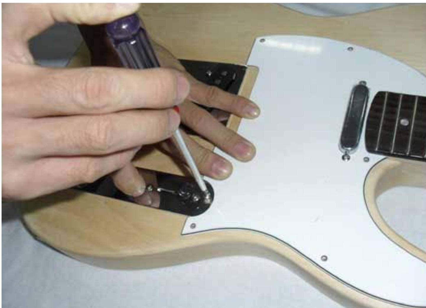
Ponga el protector, el puente y la placa de control en la cara frontal del cuerpo, de manera tal que las pastillas y todos los cables queden situados correctamente dentro de las ranuras. Procure que el protector encaje correctamente con el extremo del mástil y que esté bien posicionado frente al puente. Ahora atornille el protector con ayuda de los pequeños tornillos de cabeza redonda.
