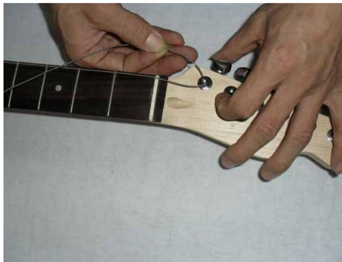
Tire la cuerda con cuidado hasta el poste de la clavija, colóquela contra el borde interior del mismo y sujétala de forma que esté tirante. Ahora enrolla la cuerda una vuelta completa alrededor del poste en sentido antihorario, manteniendo la tensión, y enhébrala a través de la ranura del poste. Esto añadirá otra vuelta por encima de la primera. Tense la cuerda girando el clavijero y monte las demás cuerdas de la manera descrita.
